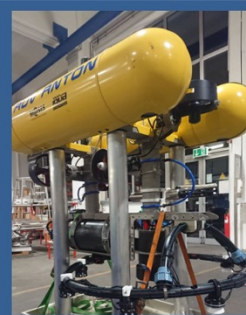
AUV ANTON (deep) (1,5 kn / 6.000 m / 1.000 kg)
