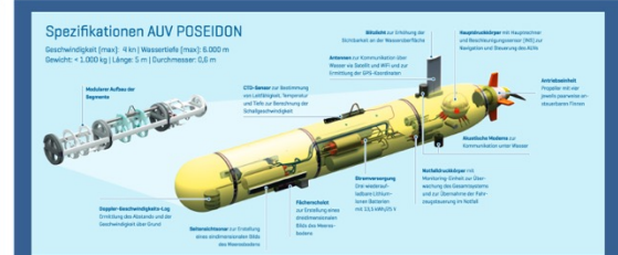
AUV POSEIDON (4 kn / 6.000 m / 1.000 kg)
